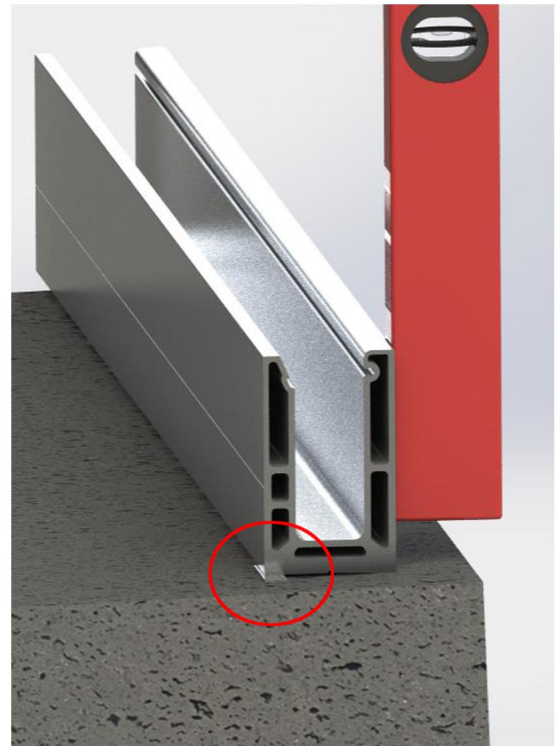
Profilin ollessa vinossa, suoristetaan se käytämällä 1,0-0,5mm paksuja ruostumatonteräs suorituslevyjä.
