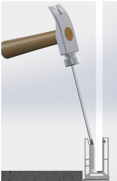
Kuva 5 - Kiilat irroitetaan avaamalla kiilaruuvit ylös saakka ja sen jälkeen lasia heilutamalla ja tarvittaessa samalla lyödään kiiloja alaspäin.
